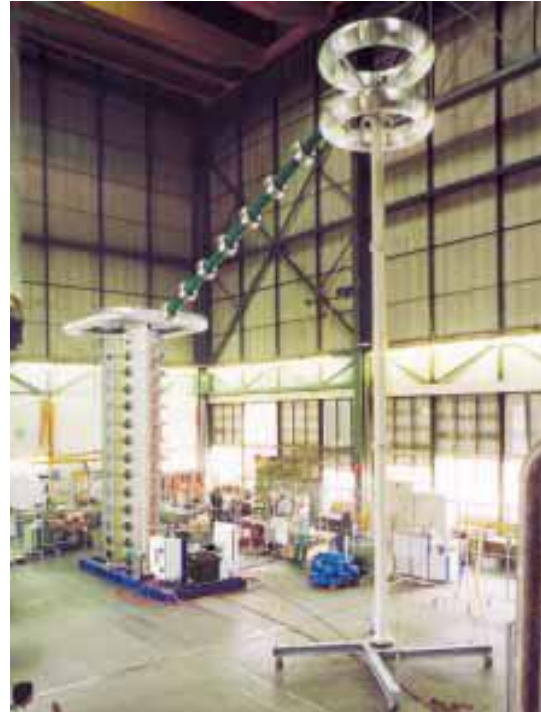
インパルス電圧試験装置 SGDA-L 1400-40 振動開閉インパルス電圧発生用
