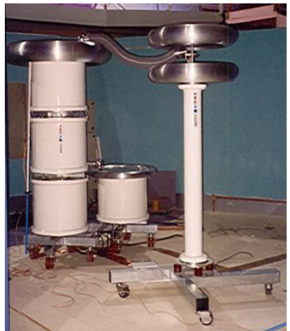
300kV (4台×PZTL 100-0.25) カスケード接続 試験用変圧器
