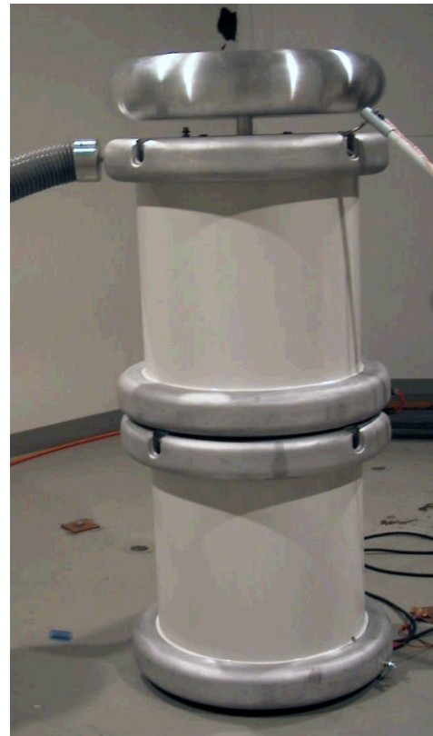
カスケード接続 試験用変圧器
