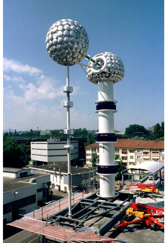
1500kV、1,2A 4段カスケード接続 試験用変圧器
