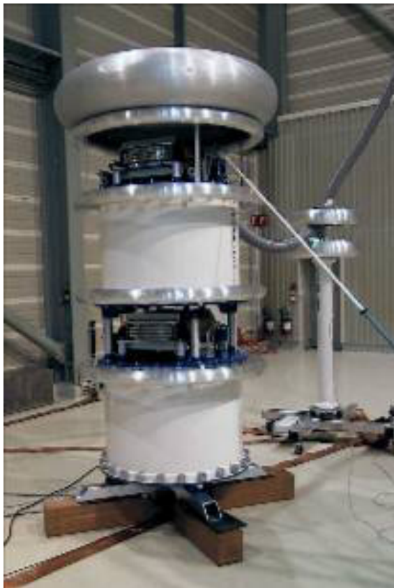
200kV 0.7A カスケード接続 試験用変圧器
