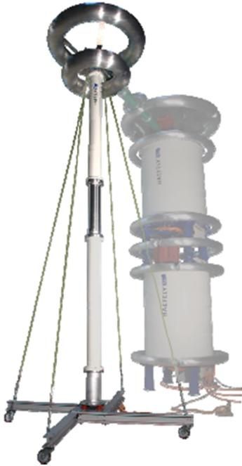
KK、TK シリーズの結合コンデンサは、電圧定格に応じて複数本の高圧ユニットで構成されています。高圧ユニットは油絶縁による紙コンデンサで、FRP 製シリンダー内部に納められています。以下の用途に最適です。
